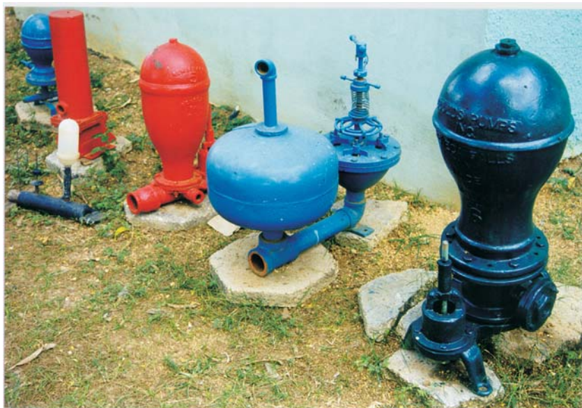
Fig. 13. Los arietes son magníficas soluciones para bombear agua sin costo energético.
