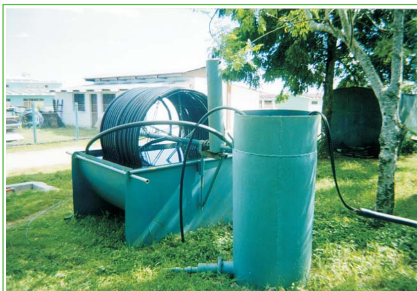
Fig. 14. Bomba de soga o cuerda que se utiliza como tecnología para abastecimiento de agua.
